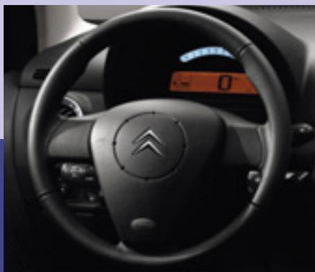
**Pilotage de précision.** Réglable en hauteur et en profondeur, le volant en cuir est parfaitement adapté à votre main. Intelligente, la direction est à assistance électrique variable en fonction de la vitesse.
