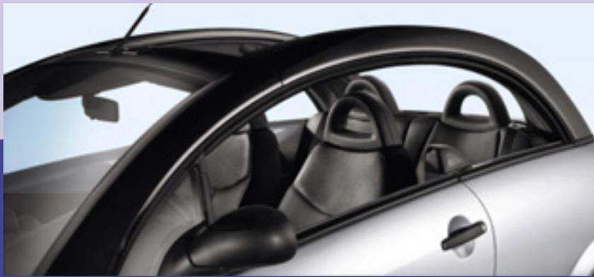
**Turbulences interdites.** Toit "coulissé", le déflecteur aéroacoustique se déploie pour neutraliser tout phénomène de battement d'air désagréable.
