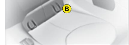
Deux anneaux **B**, situés entre le dossier et l'assise du siège du véhicule permettent de fixer un siège enfants.
