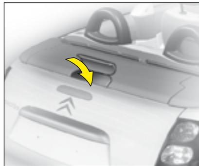
On accède à la commande d'ouverture du volet par la trappe mobile intégrée au capot de coffre.
