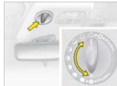
Tournez à gauche la commande pour ouvrir le toit souple. Vous disposez de 8 positions d'ouverture.
